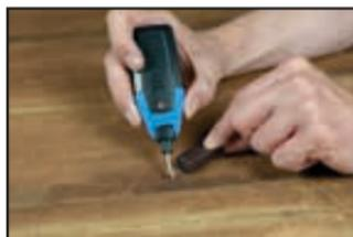
Die Schmelzerspitze wird innerhalb von wenigen Sekunden sehr heiß.
