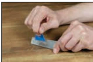
3. Reinigen Sie die Schmelzerspitze mit dem Reinigungstuch ⑥.
