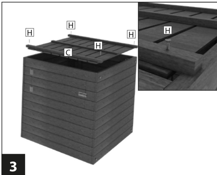
Drehen Sie den Korpus auf den Kopf. Setzen Sie den Boden **C** auf und befestigen diesen mit den Schrauben **H**.
