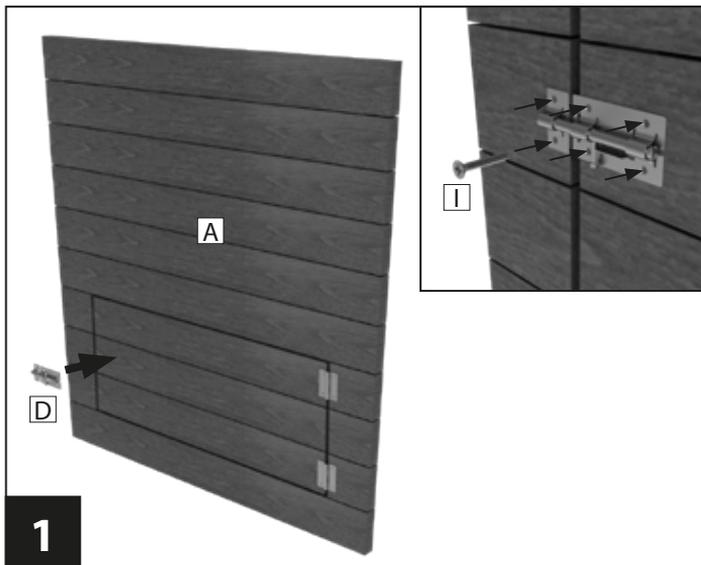
Befestigen Sie die Schließriegel **D** gemäß Bild an den Türen der Seitenteile **A**. Verwenden Sie dazu die Schrauben **I**.
