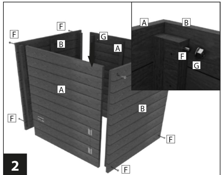
Verbinden Sie die Seitenteile **A** und **B** an den Ecken mit den Schrauben **F** und Sechskantmutter **G**.
