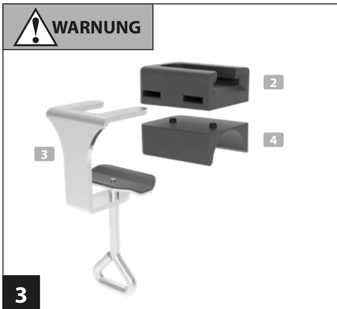
Schraubklemme **3**, Markisenhalter **2** und Rundkeil **4** gemäß Abbildung zusammensetzen.
