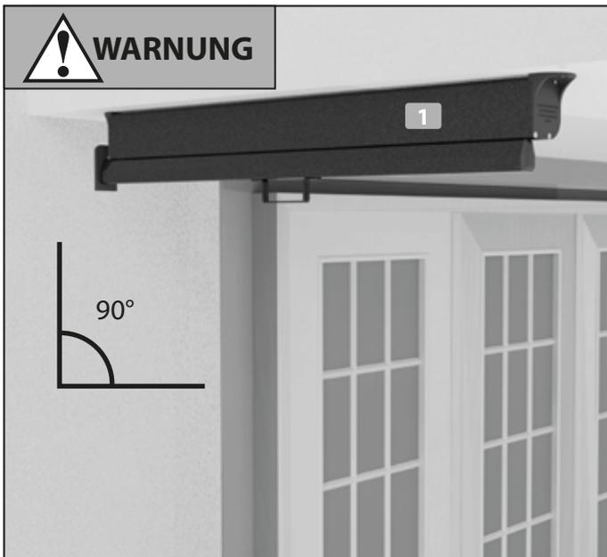
Balkonmarkise **1** an gewünschter Position anhalten. Diese Position sollte idealerweise direkt über dem Geländer sein.
