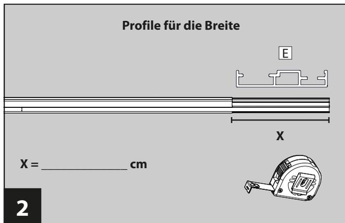
Drehen Sie die Profile um und messen Sie nun den Überstand (**X**) des Innenprofils kurz **E**. Notieren Sie sich das Ergebnis.
