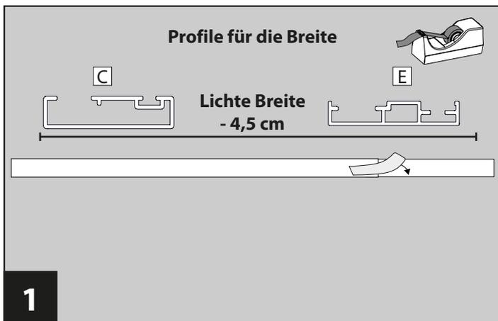
Verbinden Sie jeweils ein Außenprofil kurz **C** mit einem Innenprofil kurz **E**. Ziehen Sie diese auf das gemessene Lichte Maß für die Breite abzüglich 4,5 cm auseinander. Fixieren Sie an der glatten Außenseite (ohne Kanäle) beide Profile vorübergehend mit Klebeband. **Beispiel-Berechnung:** Lichtes Maß Breite 100 cm - 4,5 cm = 95,5 cm Auszugsmaß.
