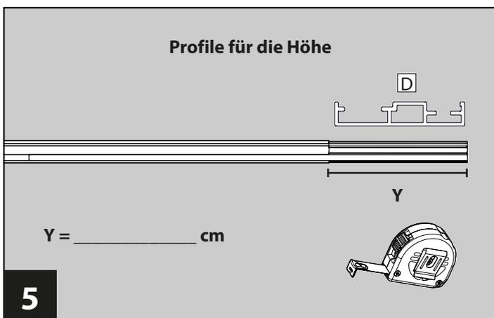
Drehen Sie die Profile um und messen Sie nun den Überstand (**Y**) des Innenprofils lang **D**. Notieren Sie sich das Ergebnis.
