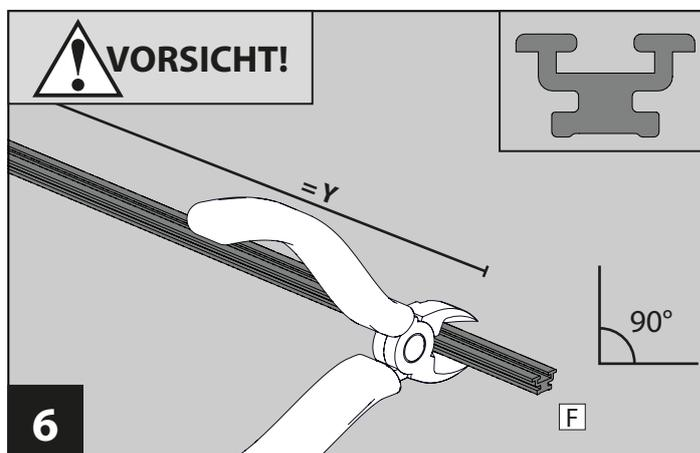
Kürzen Sie zwei Abstandsprofile lang **F** auf folgende Länge: Gemessener Überstand (**Y**) gemäß Montageschritt Nr. 5. Entgraten Sie die Schnittkanten mit einer Feile.
