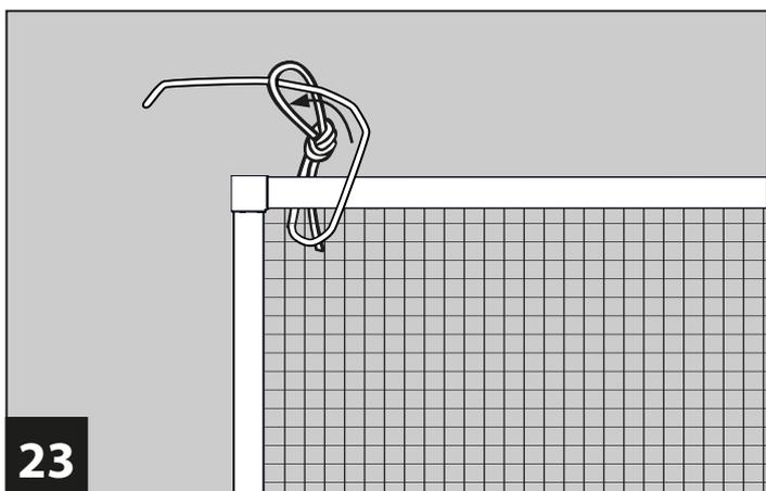
**23** Fädeln Sie das offene Ende der Sicherheitsschnur **P** an einer oberen Ecke durch das Gewebe und anschließend um den Alurahmen zurück durch die Schlaufe.
