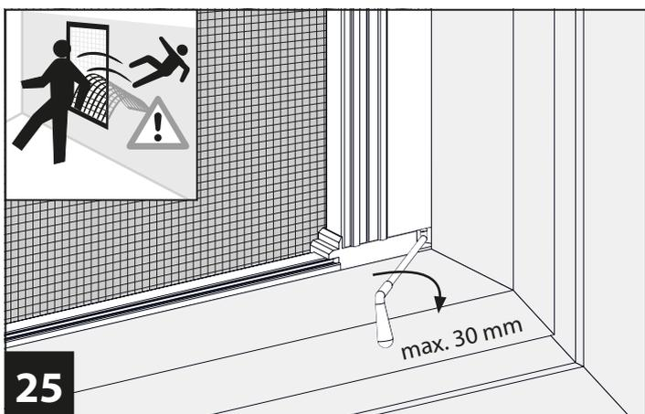
**25** Ziehen Sie alle Befestigungsfedern über den Fensterrahmen. Beginnen Sie mit den unteren Befestigungsfedern.
