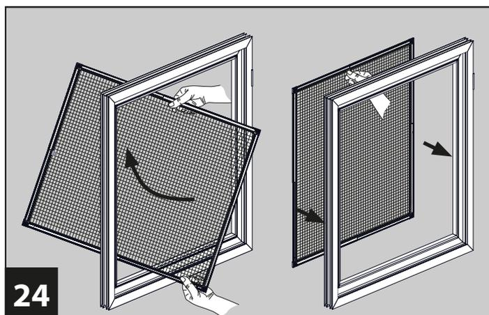
**24** Führen Sie den fertigen Bausatz von innen nach außen. Halten Sie den Bausatz am oberen Handgriff fest und halten diesen an den Fensterrahmen an.
