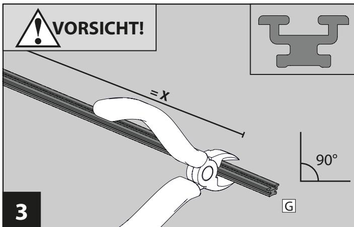
Kürzen Sie zwei Abstandsprofile kurz **G** auf folgende Länge: Gemessener Überstand (**X**) gemäß Montageschritt Nr. 2. Entgraten Sie die Schnittkanten mit einer Feile.
