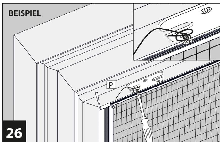
**26** Befestigen Sie die Sicherheitsschnur **P** an z. B. vorhandenen Fensterbeschlägen. Achten Sie darauf, dass sich die Sicherheitsschnur beim Schließen des Fensters locker in den Fensterrahmen legen kann. Bei Spannung kann die Sicherheitsschnur reißen.
