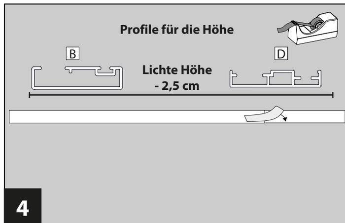
Verbinden Sie jeweils ein Außenprofil lang **B** mit einem Innenprofil lang **D**. Ziehen Sie diese auf das gemessene Lichte Maß für die Höhe abzüglich 2,5 cm auseinander. Fixieren Sie an der glatten Außenseite (ohne Kanäle) beide Profile vorübergehend mit Klebeband. **Beispiel-Berechnung:** Lichtes Maß Höhe 100 cm - 2,5 cm = 97,5 cm Auszugsmaß.
