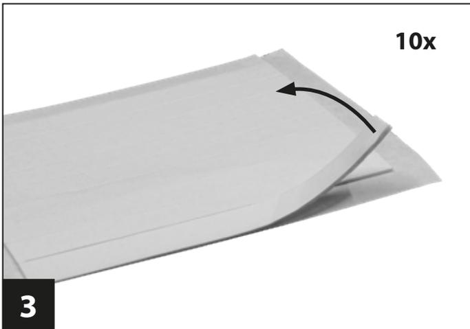
**3** Entfernen Sie die doppelseitigen Klebebänder vom Trägerpapier und kleben diese passgenau auf jeweils einen Metallstreifen **B**.
