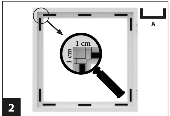
**2** **Reinigen** Sie den Fensterrahmen. Der Untergrund muss staub- und fettfrei sein. Entfernen Sie die Schutzfolie der Magnete (U-förmig) **A** und drücke diese wie abgebildet von innen an den Fensterrahmen. **TIPP:** Für eine einfachere Montage Magnete in den Ecken mit 1 cm Abstand anbringen.
