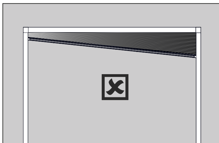
Plissee schief = ungleichmäßige Schnurspannung. Nachjustierung erforderlich.
