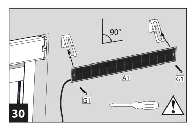
Befestigen Sie nun das Solarpanel A1 mit den Linsenkopfschrauben B1 an den beiden Wandhaltern. Dabei wird an den Wandhalter immer das außen liegende Schraubloch verwendet.
