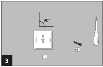
Befestigen Sie den Halter C1 mit den Schrauben H1.
