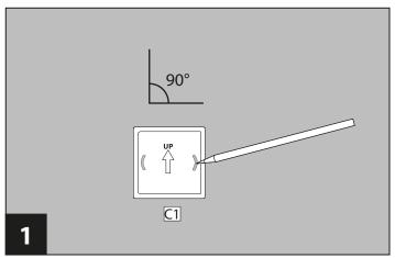
Zeichnen Sie an der gewünschten Position die Bohrlöcher unter Zuhilfenahme des Halters C1 an.
