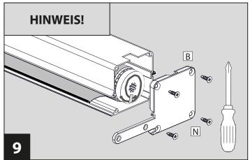
Befestigen Sie die Endkappe B mit den Schrauben N. **ACHTEN** Sie darauf, dass das Funkkabel aus Schritt 7 sich nicht löst und verklemmt wird.
