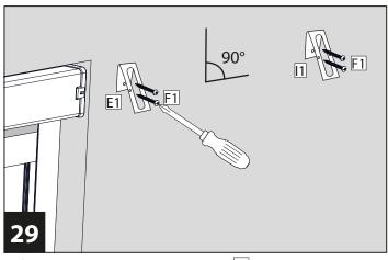
Befestigen Sie die beiden Wandhalter E1 mit den Schrauben F1.
