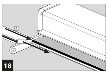
Schieben Sie die Griffleiste F über den Gewebestab auf.
