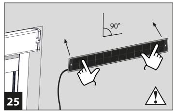
Beachten Sie für die Positionierung des Solar-Panels die Gesamtlänge des Anschlusskabels von ca. 250 cm.
