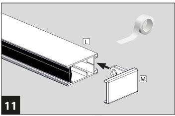
Setzen Sie nun vorab die Endfüße M auf der zuvor zugeschnittenen Seite der Führungsschienen L ein. Fixieren Sie die Endfüße vorübergehend mit einem kleinen Stück Klebeband.
