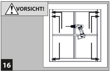
Bohren Sie die Schraublöcher an den markierten Stellen ca. 40-45 mm tief vor. Verwenden Sie dazu einen für den Untergrund passenden Bohrer der Größe Ø 6 mm.
