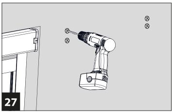
Bohren Sie die markierten Stellen min. 30 mm tief vor. Verwenden Sie dazu einen für den Untergrund und den beiliegendem Montagezubehör in Größe und Typ passenden Bohrer.
