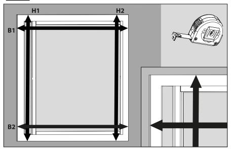
Messen Sie oben und unten an der Mauerlaibung die Breite für die Rollokassette.
