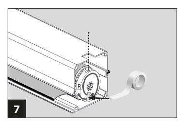
Wickeln Sie das Funkkabel des Rohrmotors R kreisförmig auf und fixieren das Funkkabel ggf. mit etwas Klebeband. Schieben Sie danach den Rohrmotor komplett in die Rollowelle ein.
