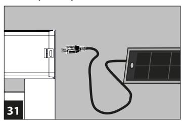
Verbinden Sie den USB-C-Stecker des Solarpanels mit dem Rohrmotor.
