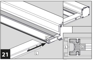
Schieben Sie die beiden Führungsschienen Lerneut auf. Dabei werden die Slider G der Griffleiste mit eingefädelt. Siehe dazu auch Detailbild.
