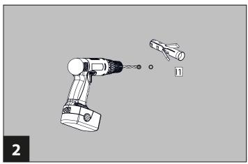
Bohren Sie die markierten Stellen 30 mm tief vor und setzen danach die Dübel 11 ein.
