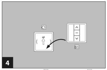
Der Funk-Fernbedienung B1 kann nun in den Halter C1 eingesetzt werden.
