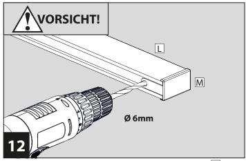
Bohren Sie das Schraubloch für die Führungsschienen Lanhand der eingesetzten Endfüße M vor.
