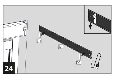
Beachten Sie für die Positionierung des Solarpanels die Gesamtlänge des Anschlusskabels von ca. 250 cm.
