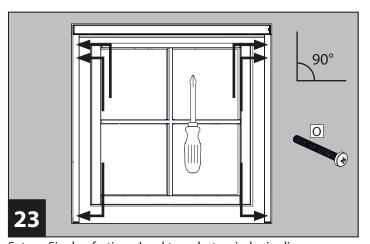
Setzen Sie den fertigen Insektenschutz wieder in die Mauerlaibung ein und richten diesen erneut aus. Entfernen Sie ggf. verwendete Klebebänder.
