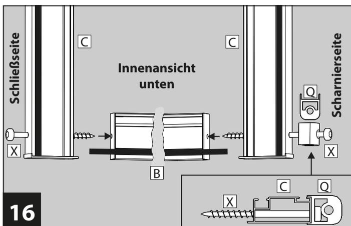
Verbinden Sie die Höhenprofile **C** unten mit Querprofil **B** mittels Torx-Schrauben **X**. **Achtung!** Auf Scharnierseite muss das Scharnier **Q** mit der Torx-Schraube **X** befestigt werden. **Hinweis:** Ziehen Sie die Schrauben im Wechsel gleichmäßig an. Die Schrauben nur handfest anziehen. Bei Verwendung eines Akkuschaubers das Drehmoment reduzieren.
