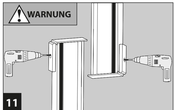
Bohren Sie die Höhenprofile gemäß Vorgabe der Bohrschablone mit Metallbohrer komplett durch. Scharfe Kanten abfeilen oder entgraten. **Hinweis:** Legen Sie den Bohrer so in die Bohrmaschine ein, dass dieser in der Länge komplett quer durch die Profile inkl. Bohrschablone passt.
