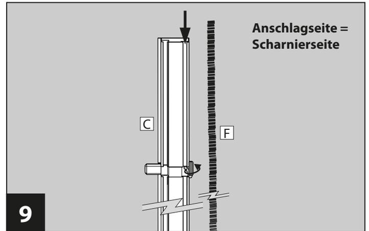
Ziehen Sie die Bürstendichtung **F** gemäß Abbildung in den äußeren Kanal der Höhenprofile **C** auf der Scharnierseite ein.
