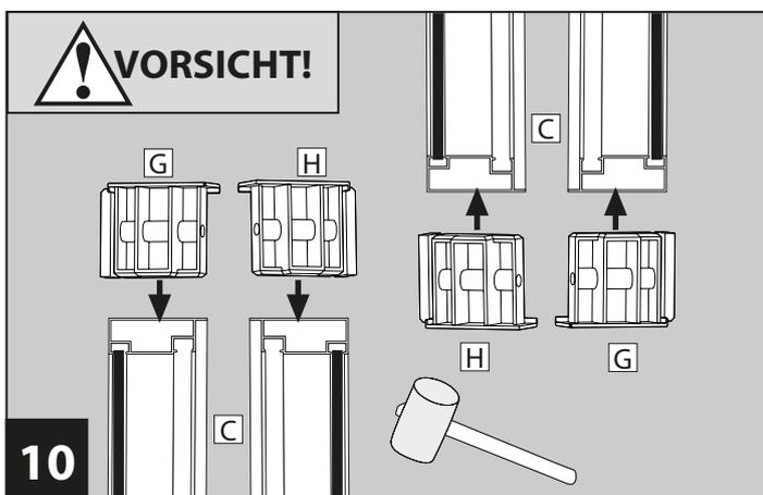
Verbinder Höhenprofile (Bohrschablone integriert) **G** und **H** in die oberen und unteren Höhenprofile **C** einsetzen.
