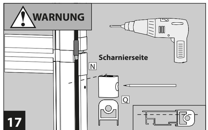
**Scharnierseite:** Halten Sie das mittlere Scharnier **Q** im Abstand von 0,5 cm unterhalb der Abdeckkappe **N** auf Scharnierseite an und markieren das Bohrloch. Markierte Position mit Metallbohrer max. 1,5 cm tief vorbohren, **nicht** durchbohren. **Achten** Sie bei dem Markieren/Bohren auf die Richtung des Schraubloches (siehe auch Detailabbildung).
