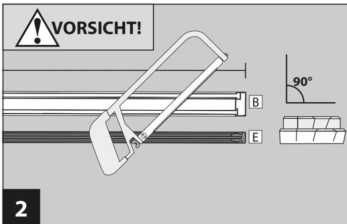
Kürzen Sie die Querprofile **B** und 2 Stück Klemmleisten **E** auf das Maß „B“ - 2,2 cm.
