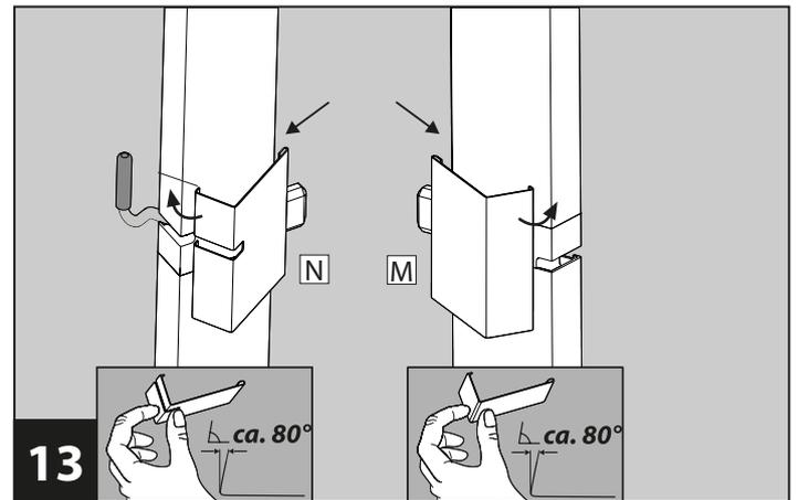
Setzen Sie die Abdeckkappe **M** auf Schließseite und Abdeckkappe **N** auf Scharnierseite auf. Beide Abdeckkappen von innen nach außen aufstecken und nach hinten umlegen. Abdeckkappen mittig ausrichten.
