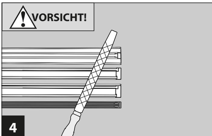
Entgraten Sie die Schnittflächen mit einer Metallfeile.
