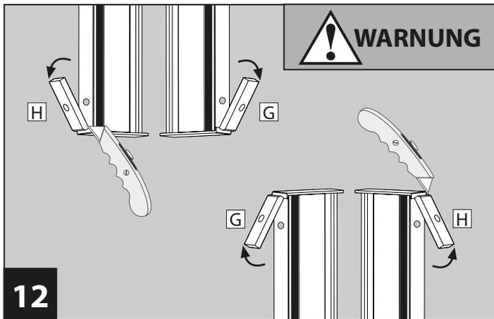
Entfernen Sie die Bohrschablonen von den Verbindern **G** und **H** mit z. B. einem Cuttermesser.
