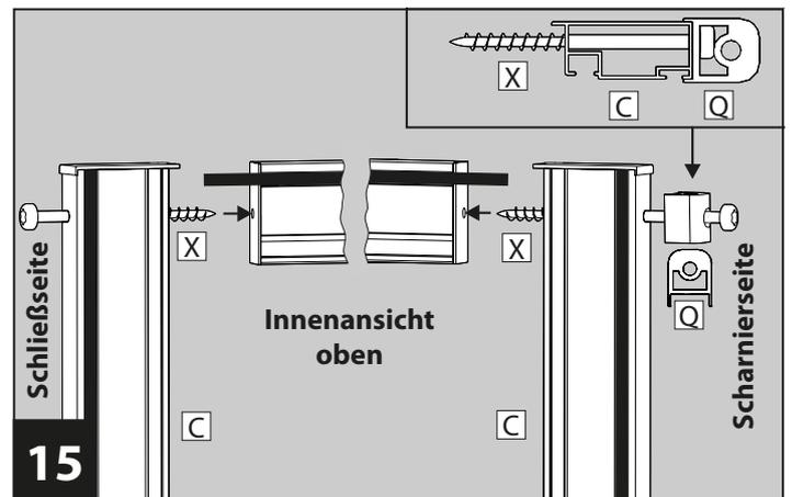
Verbinden Sie die Höhenprofile **C** oben mit Querprofil **B** mittels Torx-Schrauben **X**. **Achtung!** Auf Scharnierseite muss das Scharnier **Q** mit der Torx-Schraube **X** befestigt werden.
