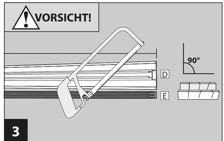
Kürzen Sie das Griffprofil **D** auf das Maß „B“ abzüglich 2 cm. Kürzen Sie 1 Stück Klemmleiste **E** auf das Maß „B“ abzüglich 12 cm. **Achten** Sie auf einen sauberen und geraden Schnitt. Nach Möglichkeit eine Gehrungslade verwenden.
