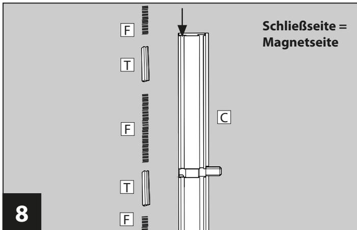
Schieben Sie die Magnete **T** und die Bürstendichtung **F** im Wechsel gemäß Abbildung in den äußeren Kanal der Höhenprofile **C** auf der Schließseite ein.
