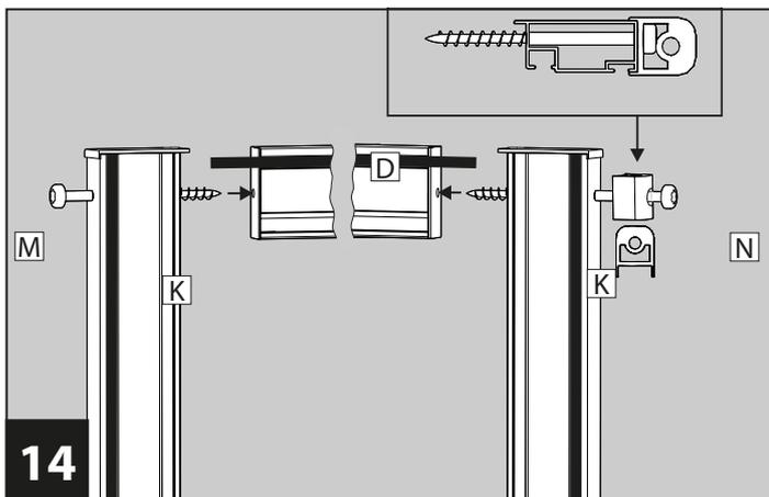
Verbinden Sie die vorbereiteten Höhenprofile mit Griffprofil **D**. **Achten** Sie darauf, dass die Abdeckkappen **M** und **N** an den T-Verbindern **K** mittig ausgerichtet sind.
