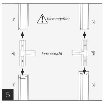
Profile B mit den T-Verbindern N verbinden.
