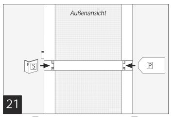
Außengriff P und Abdeckplatte des Türschließers S aufstecken.
