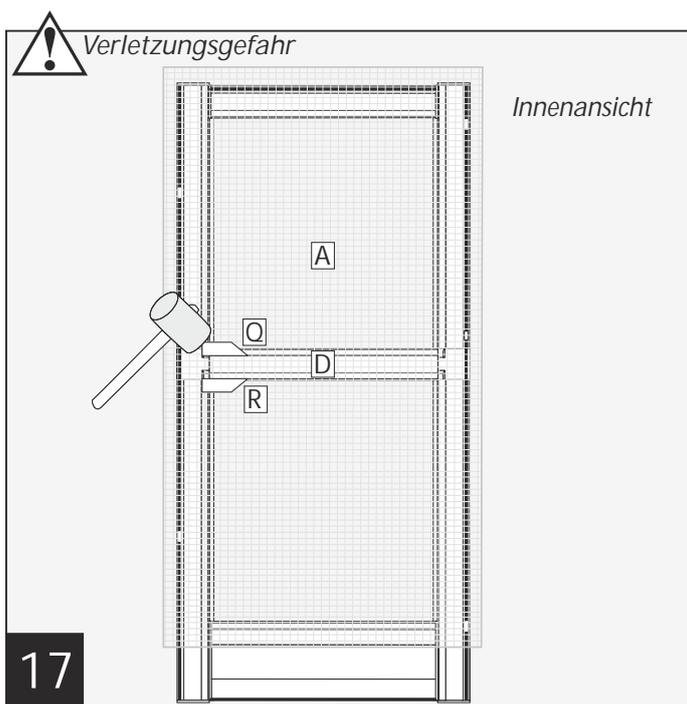
Innengriffe **Q** und **R** gegenüber der Scharnierseite in die Nut des Mittelprofils **D** einschlagen.
