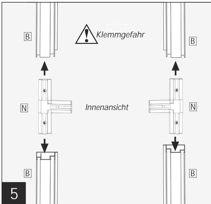
**5** Profile **B** mit den T-Verbindern **N** verbinden.
