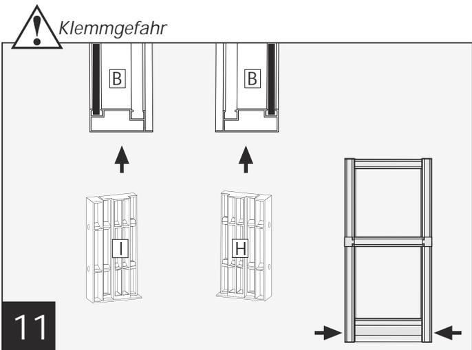
Die Verbinder inkl. Bohrschablone **I** und **H** unten in die Längsprofile **B** einschlagen.
