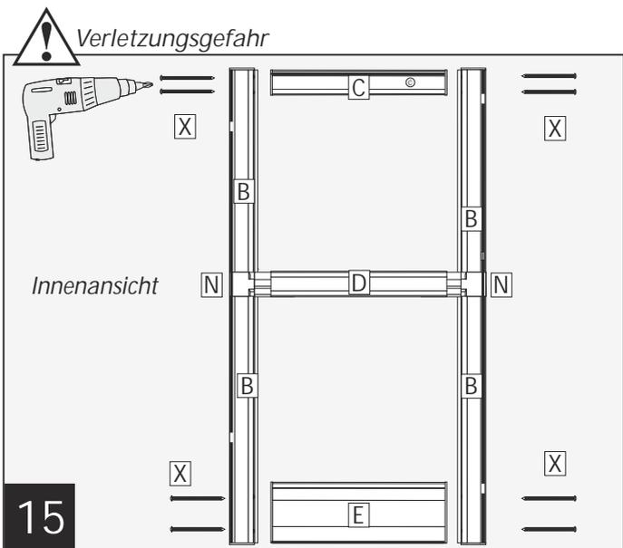
Mittelprofil **D** mit T-Verbinder **N** verbinden. Längsprofile **B** mit dem Querprofil **C** und dem Trittschutzprofil **E** mittels Schrauben **X** verbinden.
