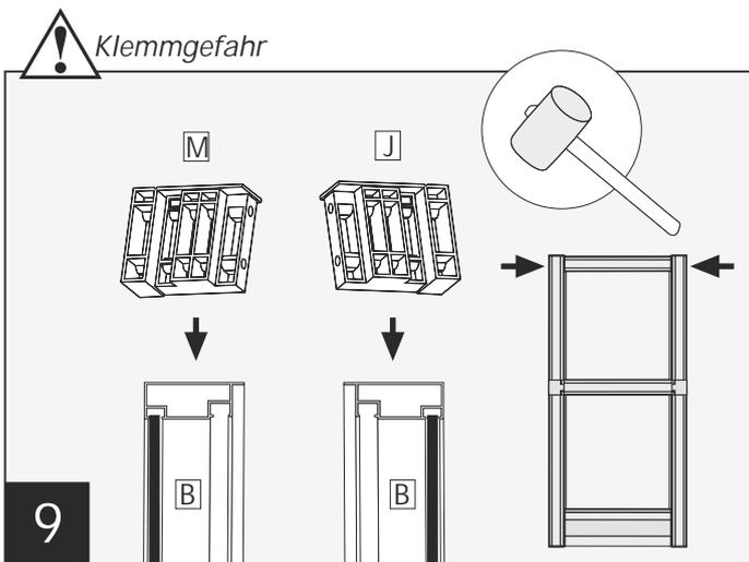
Die Verbinder inkl. Bohrschablone **M** und **J** oben in die Längsprofile **B** einschlagen.
