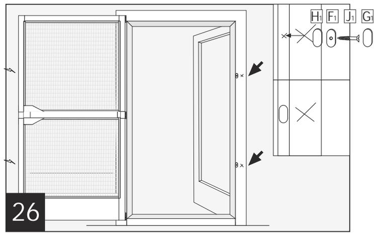
Durch Anbringung der zwei Magnetplatten **F1** an den markierten Positionen, ist eine optimale Schließung gewährleistet. Die Magnetplatten **F1** können wahlweise mittels Schrauben **J1** am bestehenden Türrahmen verschraubt oder mit dem doppelseitigen Klebeband **H1** angeklebt werden. Die Schutzfolie **G1** schützt den Insektenschutzrahmen vor Kratzern. Hinweis: Achten Sie darauf, dass die Magnetplatten **F1** bündig mit der Außenkante der Profile **B** abschließen.
