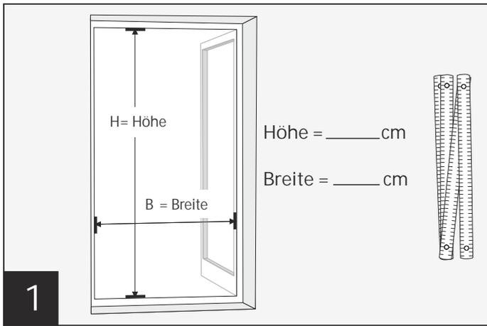
**1** Sorgfältig die Breite „B“ und Höhe „H“ des Türrahmens in „cm“ ausmessen. Wichtig: Messen Sie das lichte Maß von Innenkante zu Innenkante. Achtung: Bei nach außen abgeschrägten Türrahmen immer von der äußersten Kante messen.
