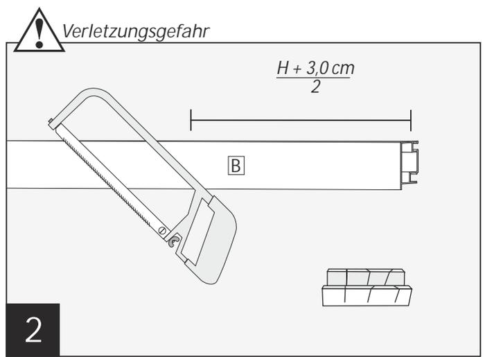
**2** Die 4 Profile **B** auf die genaue Höhe „H“ + 3,0 cm geteilt durch 2 kürzen. Achten Sie auf einen sauberen und geraden Schnitt. Nach Möglichkeit eine Gehrungslade verwenden. Bsp.:  $\frac{H 197 \text{ cm} + 3,0 \text{ cm}}{2} = 100 \text{ cm}$  (je Profil)
