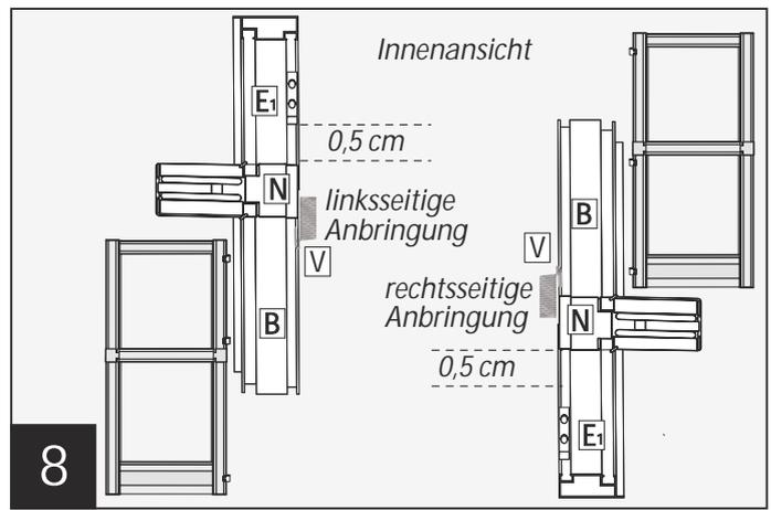
Bei Wahl des automatischen Türschließers **V** muss der mittlere Nutenstein **E<sub>1</sub>** bei linksseitiger Anbringung 0,5 cm oberhalb des T-Verbinders **N** und bei rechtsseitiger Anbringung 0,5 cm unterhalb des T-Verbinders **N** angebracht werden.
