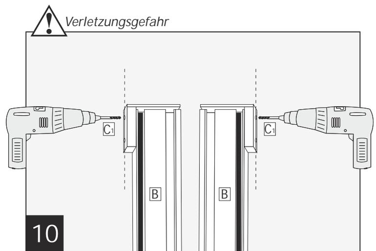
Profile **B** gemäß Vorgabe der Bohrschablone mit Metallbohrer **C<sub>1</sub>** komplett durchbohren. Scharfe Kanten abfeilen oder entgraten.
