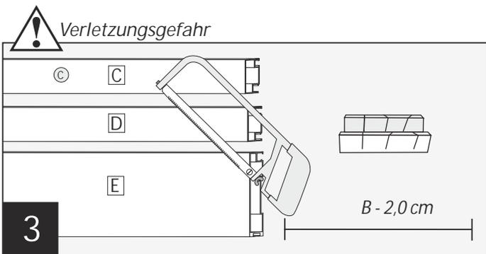
**3** Die Profile **C**, **D** und **E** auf das Maß „B“ abzüglich 2,0 cm kürzen. Achten Sie auf einen sauberen und geraden Schnitt. Nach Möglichkeit eine Gehrungslade verwenden. Bsp.:  $B 85 \text{ cm} - 2,0 \text{ cm} = 83 \text{ cm}$
