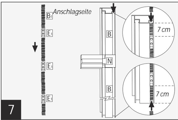
Die Bürstendichtung **B** und Nutensteine **E<sub>1</sub>** im Wechsel gemäß Abbildung in den äußeren Kanal der Längsprofile **B** auf der Scharnierseite einziehen.
