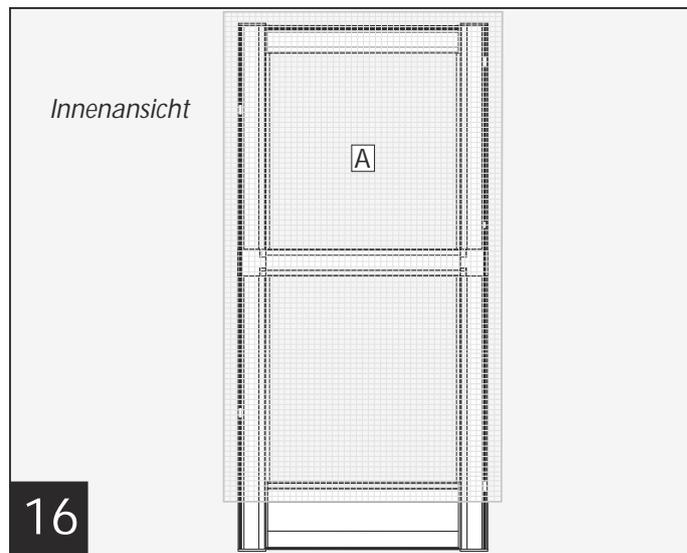
Das Fiberglasgewebe **A** lose und ungespannt auf den Alurahmen legen.
