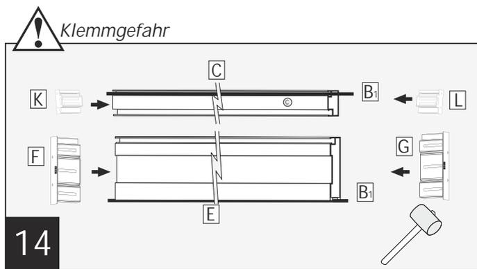
Bürstendichtung **B<sub>1</sub>** in die dafür vorgesehene kleinere Nut des Querprofils **C** und des Trittschutzprofils **E** einziehen. Anschließend Verbinder **L** und **K** in das Querprofil und die Verbinder **G** und **F** in das Trittschutzprofil einschlagen.
