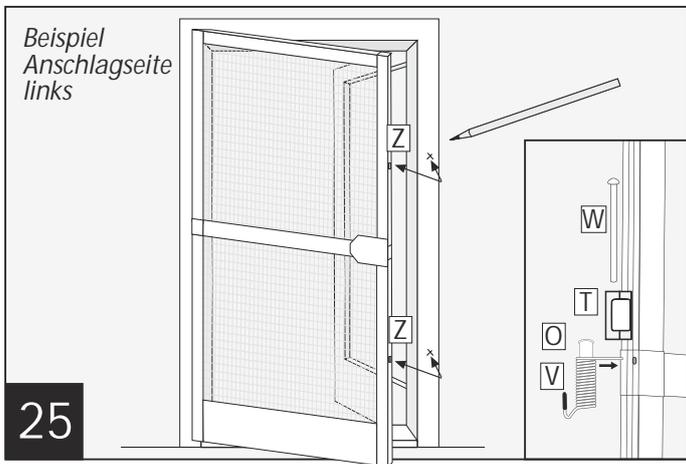
Wahlweise ist eine Anbringung eines automatischen Türschließers **V** möglich. Buchse **O** in den Türschließer **V** einstecken. Den Türschließer **V** mit dem großen Befestigungsstab **W** anstatt des kleinen Befestigungsstabes **Y** am mittleren Scharnier **T** anbringen. Tipp: Für das Anbringen des automatischen Türschließers **V** die Tür etwas öffnen. Die Position der Magnete **Z** am bestehenden Türrahmen anzeichnen.
