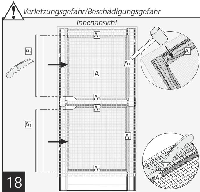
Klemmleisten auf die Länge des jeweiligen Alu-Profiles kürzen. Durch Einschlagen der Klemmleisten **A<sub>1</sub>** in die Nut der Aluprofile (**B|C|D|E**) das Fiberglasgewebe **A** befestigen. Anschließend das überstehende Fiberglasgewebe mit einem Cuttermesser kürzen.
