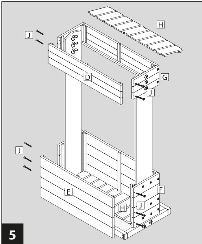
Seitenteile Pflanzkasten klein **D** und groß **E** mittels Kreuzschlitzschrauben **J** mit den Frontteilen Pflanzkasten groß **F** und klein **G** verschrauben. Einlegeböden **H** in den oberen und unteren Pflanzkasten einsetzen.
