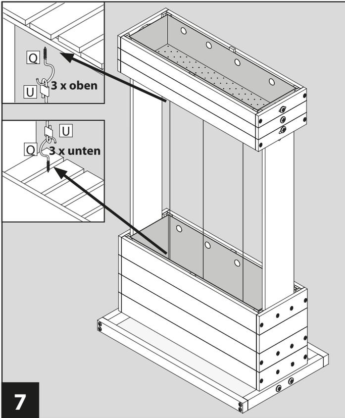
Jeweils drei Schraubhaken **Q** an die Unterseite des oberen Einlegebodens **H** eindrehen und je Schraubhaken **Q** ein Rankseil **U** einhängen. Die anderen Enden der Rankseile **U** jeweils in einen Schraubhaken **Q** einhängen und die Schraubhaken **Q** auf die Oberseiten des unteren Einlegebodens **H** eindrehen.
