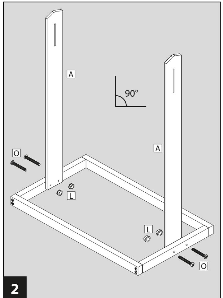
Seitenteile **A** mittels Kreuzschlitzschrauben **O** und Sechskantmutter **L** von innen an vormontierten Standfuß befestigen.
