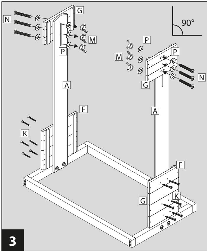
Frontteile Pflanzkasten klein **G** jeweils beidseitig an Seitenteile **A** mittels Kreuzschlitzschrauben **N**, Unterlegscheiben **P** und Flügelmuttern **M** befestigen. Frontteile Pflanzkasten groß **F** jeweils beidseitig an Seitenteile **A** unten mittels Kreuzschlitzschrauben **K** befestigen.
