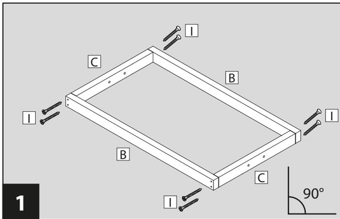
Standfüße lang **B** mit Standfüße kurz **C** mittels Kreuzschlitzschrauben **I** verbinden.
