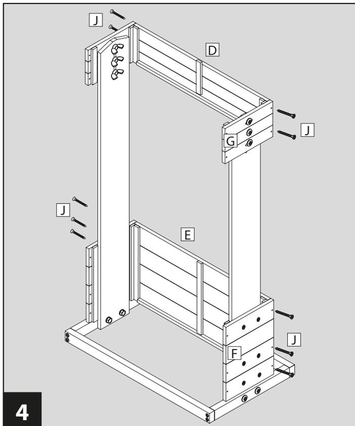
Seitenteile Pflanzkasten klein **D** und groß **E** mittels Kreuzschlitzschrauben **J** mit den Frontteilen Pflanzkasten groß **F** und klein **G** verschrauben.
