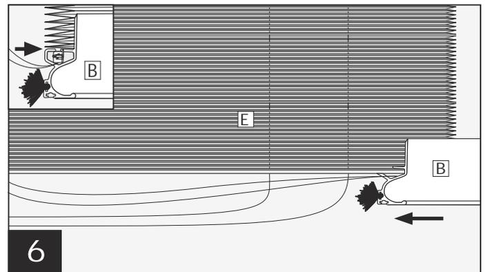
Griffleiste **B** einsetzen. Nehmen Sie zunächst die beiden linken Schnüre und legen Sie diese in die Führungsnut der Griffleiste **B**. Schieben Sie die Griffleiste **B** anschließend seitlich von rechts nach links auf das Plisseegeewebe **E**. Das Ende der linken Schnur befindet sich nun auf der rechten Seite, das Ende der rechten Schnur auf der linken Seite!
