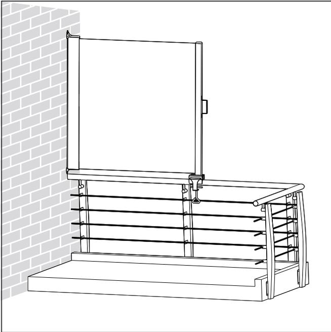
Für Rundgeländer mit einem Durchmesser von mindestens 2,0 cm bis maximal  $\varnothing$  5 cm. **Achtung!** An Rundgeländern besteht die Gefahr des Abkippens.
