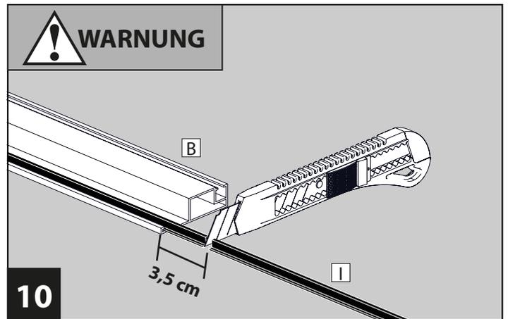
Schieben Sie auf der Scharnierseite die Bürstendichtung **I** auf die komplette Höhe ein. Kürzen Sie die Bürstendichtung **I** mit einem Überstand oben und unten von jeweils 3,5 cm.
