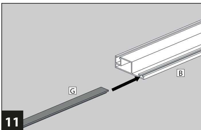
Schieben Sie die beiden Magnetbänder **G** auf der Schließseite (= Seite ohne Scharniere) von oben und unten ein.
