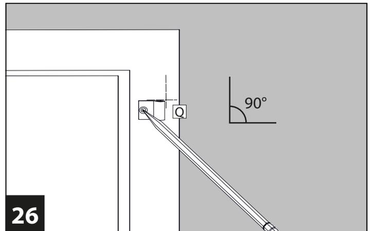
Halten Sie die Scharniere **Q** oben und unten unterhalb der markierten Positionen an. Markieren Sie jeweils das Schraubloch.
