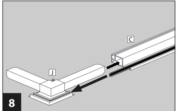
Setzen Sie die Eckverbinder **J** jeweils links und rechts auf die Breitenprofile **C**. Achten Sie darauf, dass die Bürstendichtung dabei in die Eckverbinder **J** mit eingeschoben wird. Verwenden Sie bei Schwergängigkeit einen Gummihammer. **Achtung:** Die Bürstenkanäle an den Eckverbindern dürfen nicht beschädigt werden.
