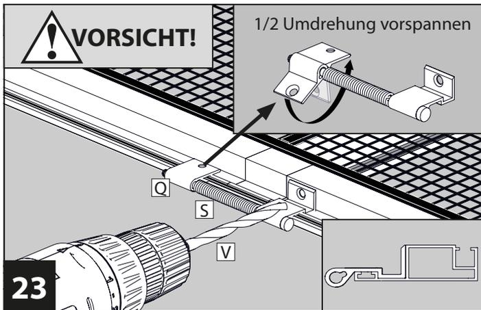
Bringen Sie das Scharnier **Q** des Türschließers **S** mit einer halben Drehung auf Vorspannung (siehe Detailbild). Halten Sie den Türschließer **S** mittig am Mittelverbinder **M** an. Bohren Sie das Schraubloch mit dem Bohrer **V** vor. **Achtung:** Bohren Sie max. 1 cm tief. Verwenden Sie ggf. einen Tiefenanschlag, sofern vorhanden (siehe auch „Häufige Fragen auf Seite 15). **Bohren Sie keinesfalls das komplette Profil durch.**
