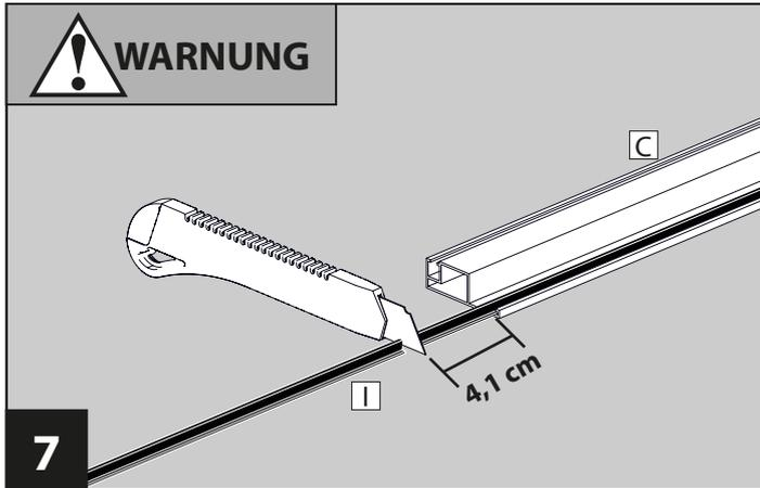
Schieben Sie die Bürstendichtung **I** in die Breitenprofile **C**. Kürzen Sie die Bürstendichtung **I** mit Überstand links und rechts von jeweils 4,1 cm.
