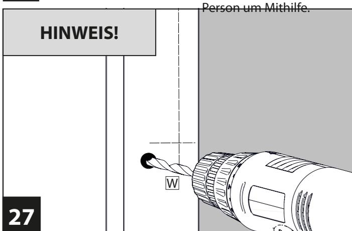
Bohren Sie die markierten Stellen mit einem  $\varnothing 2,5$  mm Bohrer vor (Je nach Untergrund richtigen Bohrertyp verwenden).
