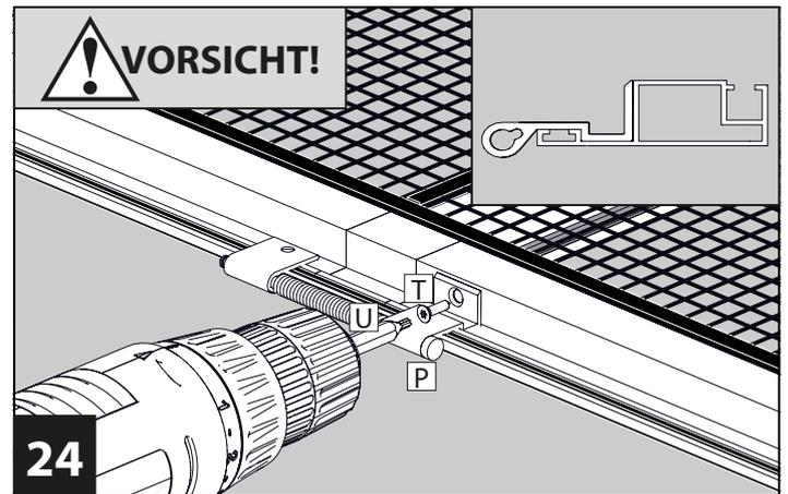
Befestigen Sie den Scharnierhalter **P** des Türschließers **S** mit einer Schraube **T**. Verwenden Sie dazu den Torx-Bit **U**. **Hinweis:** Reduzieren Sie das Drehmoment um ein Durchdrehen der Schraube zu vermeiden.
