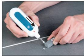
4. Schmelzen Sie mit der Schmelzerspitze kleine Portionen aus den Wachsstangen ab und bringen Sie diese portionsweise in die Schadstelle ein, bis sie leicht überfüllt ist.
