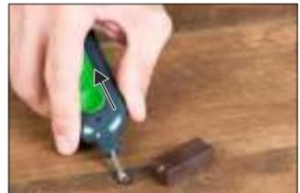
7. Tragen Sie die Wachsüberstände ab, indem Sie mit der Spachtel **8** mit leichtem Druck über die Schadstelle vor und zurück fahren.
