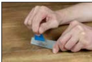
3. Reinigen Sie die Schmelzerspitze mit dem Reinigungstuch **6**.
