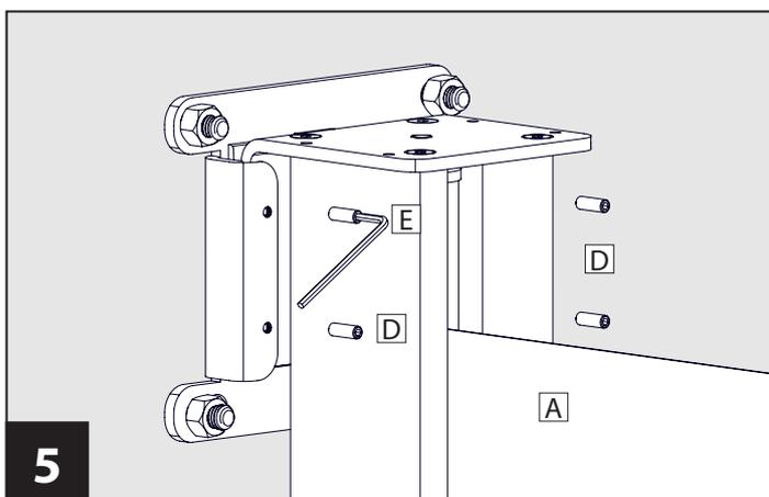
**5** Fixieren Sie die Balkonmarkise **A** durch Festdrehen der vier Innensechskantschrauben **D** mit dem mitgelieferten Innensechskantschlüssel **E**.
