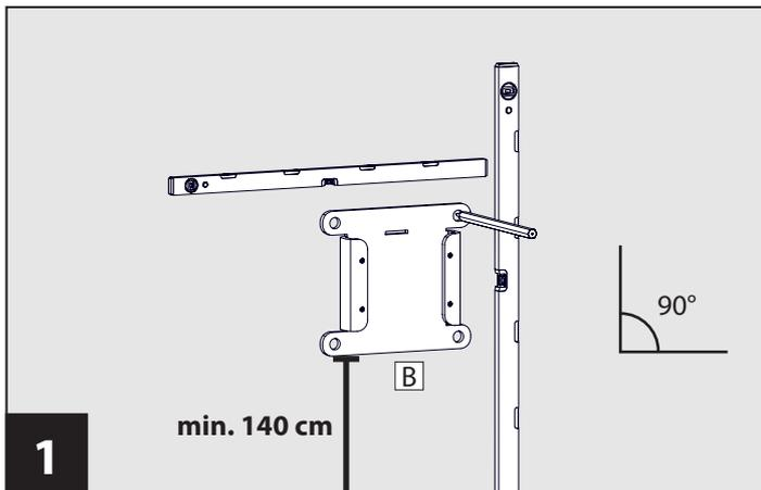
**1** Halten Sie die Wandplatte **B** an gewünschter Position auf eine Mindesthöhe von 140 cm an und zeichnen alle Bohrlöcher an. **Achten** Sie auch auf eine gerade Ausrichtung.
