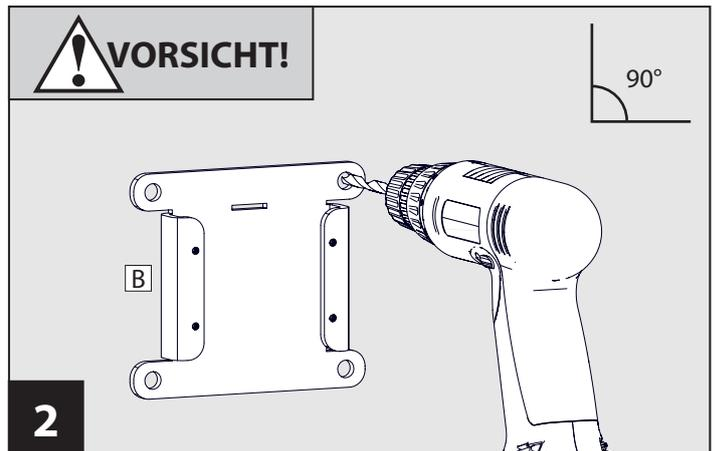
**2** Bohren Sie alle angezeichneten Positionen für die Wandplatte **B** vor. Verwenden Sie dazu einen dem Untergrund angepassten Bohrer.
