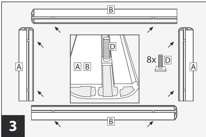
3 Befestigungsschrauben einsetzen.
