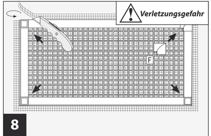
Gitterrost drehen und Gewebe mit einem Cuttermesser kürzen.
