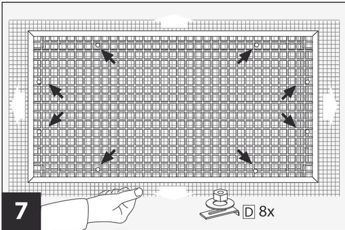
Alurahmen am Gitterrost befestigung.
